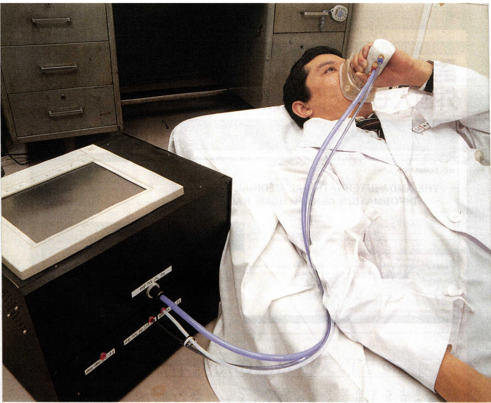
喘息患者が自ら装着できる緊急補助呼吸システム。呼気の排出、吸気の流入などのため、3本の管が伸びている。試作機は20kgもあるが、3分の1程度には軽量化可能という
