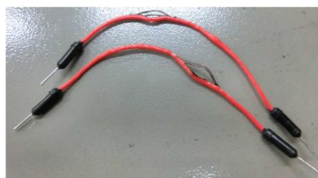
図2 過電流により焦げたケーブル
